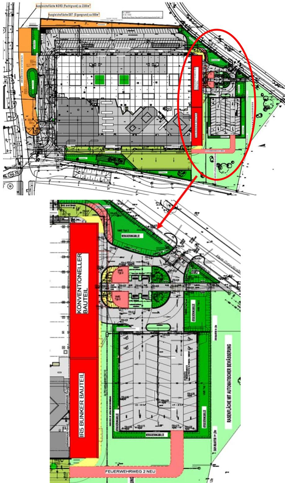
Abbildung 1: Bestehende Anlage MedAustron und Verortung des geplanten Zubaus mit den beiden Bauteilen farblich in Rot dargestellt. Details können aus dem Plan Nr. „B.03-01 P01 1.0 A Grundriss Erdgeschoss“ entnommen werden.
